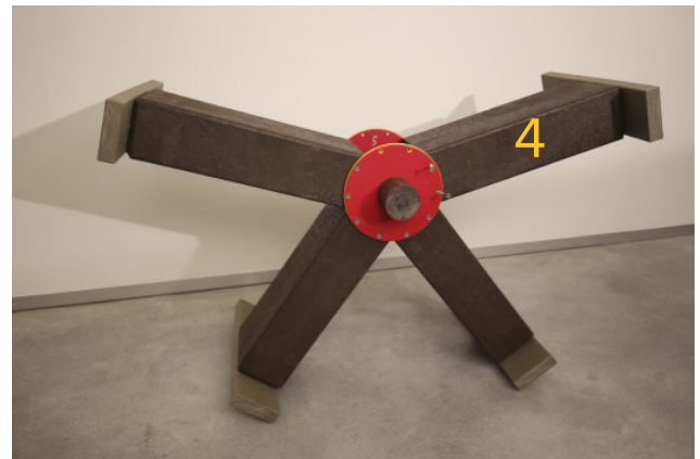
Schroef de bovenplaat vast op arm 4 en zet het reeds gemonteerde deel recht, schroef de onderplaat vast op arm.
