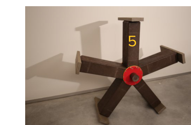
Schroef de bovenplaat vast op arm 5 en zet het reeds gemonteerde deel recht, schroef de onderplaat vast op arm.
