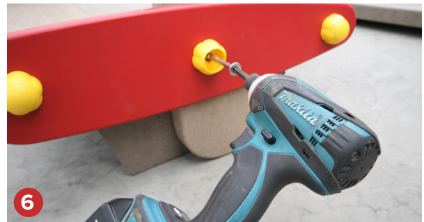
6 Monteer de vleugelsteunen met de 2 bijgeleverde schroeven van 8 x 120 ( Torx 40) en de 2 gele afdekkapjes.
